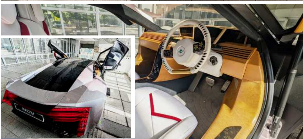
「NCV (Nano Cellulose Vehicle) プロジェクト」で製造されたコンセプトカー。16%の軽量化と11%の燃費向上を実現した
