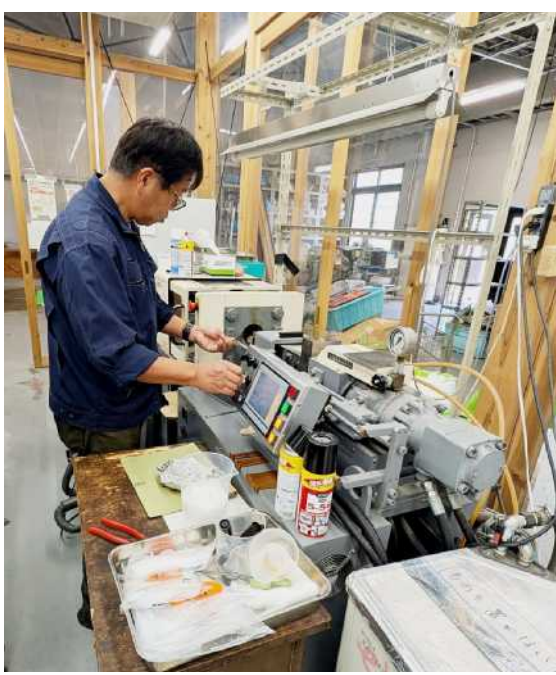
京都プロセス(パルプ直接混練法)は2軸押出混練機でパルプのナノ解繊と樹脂中への分散をワンショットで行う
