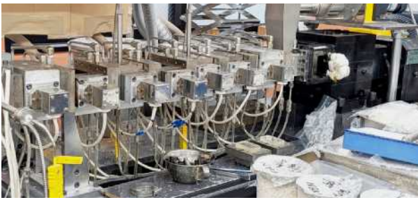
京都プロセス(パルプ直接混練法)は2軸押出混練機でパルプのナノ解繊と樹脂中への分散をワンショットで行う
