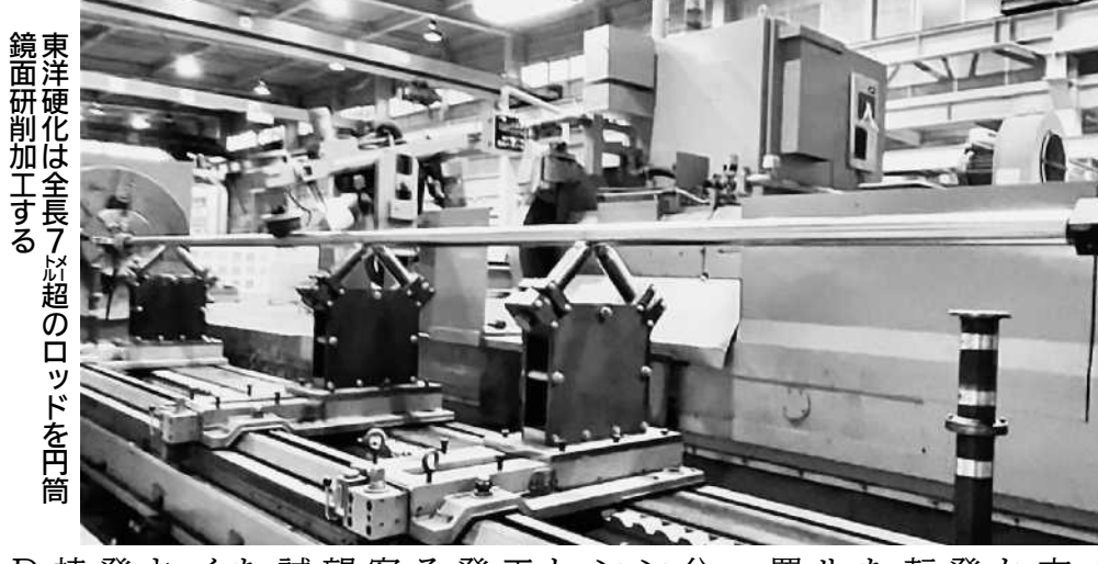
東洋硬化は全長7m超のロッドを円筒鏡面研削加工する
