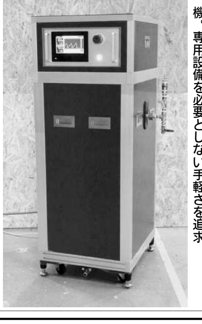
東明工業の工場エアーを利用する簡易型内圧加圧試験機。専用設備を必要としない手軽さを追求
