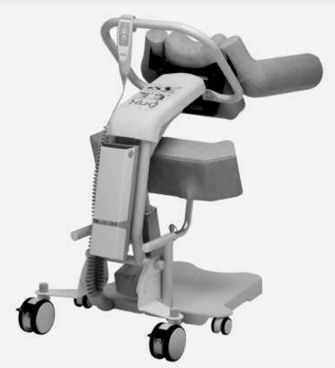
FUJIIの在宅介護向け移乗サポートロボットの新型「Hug L1-02」
