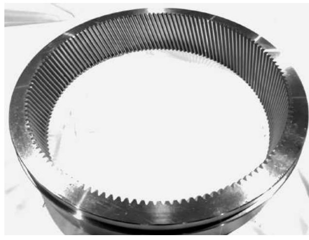
島製作所は高精度なヘリカルギヤの内歯車を加工する
