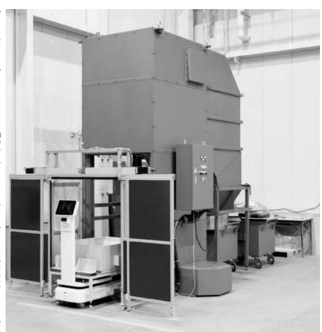
白山機工が開発したAMRを使った切りくず自動回収システム
