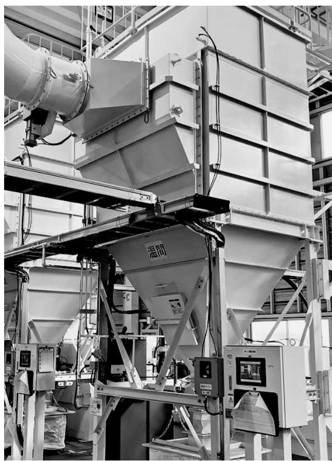
今年度内は藤岡工場のコイルラインにある約20台の全集塵機を対象に、異常を早期に検知する自動管理システムを導入する
