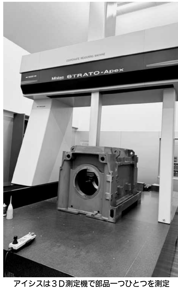
アイシスは3D測定機で部品一つひとつを測定
