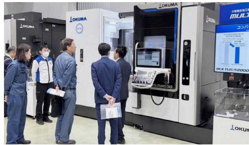
製造現場の人手不足を背景に、工作機械では工程集約機の需要拡大が見込まれる(オークマの小型複合加工機「マルチスU2000」)
