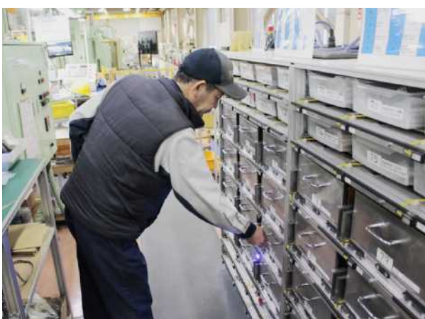
開閉器の付属品は収納場所の棚が光る「ピッキングシステム」を採用
