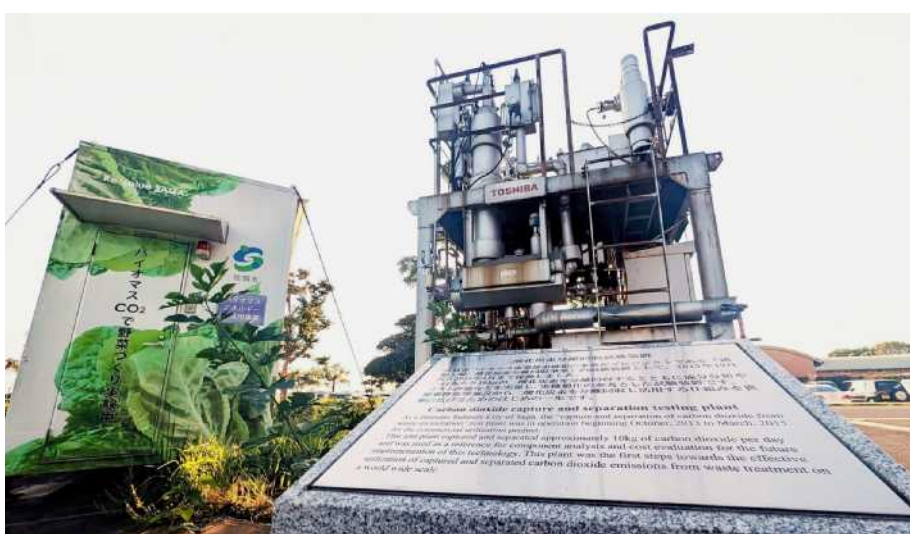
モニュメントとして残されている実証試験機。小型CO 2 分離回収試験装置(右)と野菜栽培施設。実証運転は累計8000時間を超える
