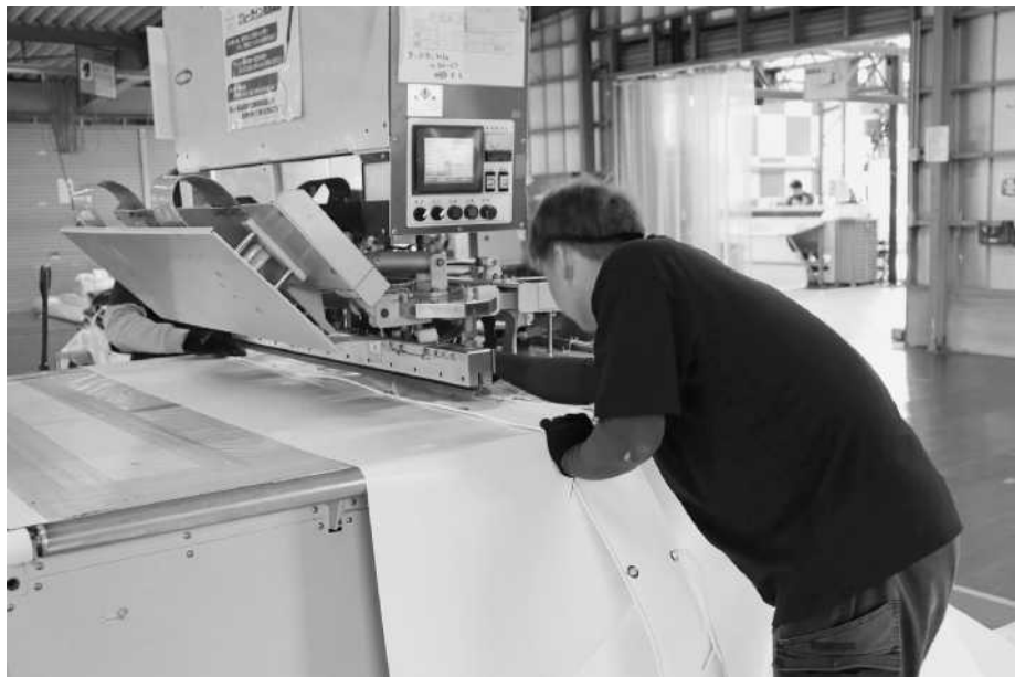
テントの溶着工程では作業を細分化することで生産効率向上を実現した
