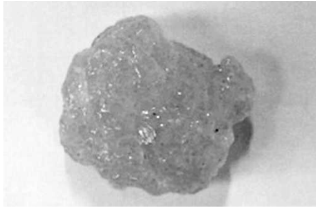
ラボ設備で試作した炭素資源循環型ブタジエンゴム
