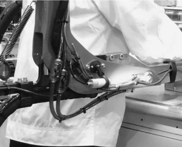
電極交換時に冷却水がこぼれるを防ぐ「止水バルブ」
