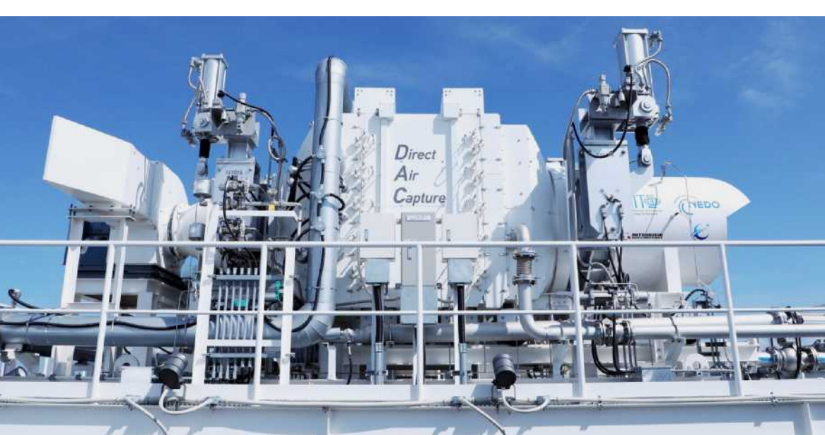
実証機3基には構造や素材が異なる基材が使用され、圧力損失やCO 2 の捕捉性能などを比較している
