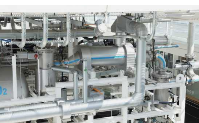
DAC装置で空気から分離・回収されたCO 2 濃度は95%以上
