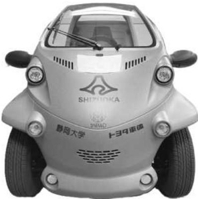
県産木材射出材料による自動車ボディー
