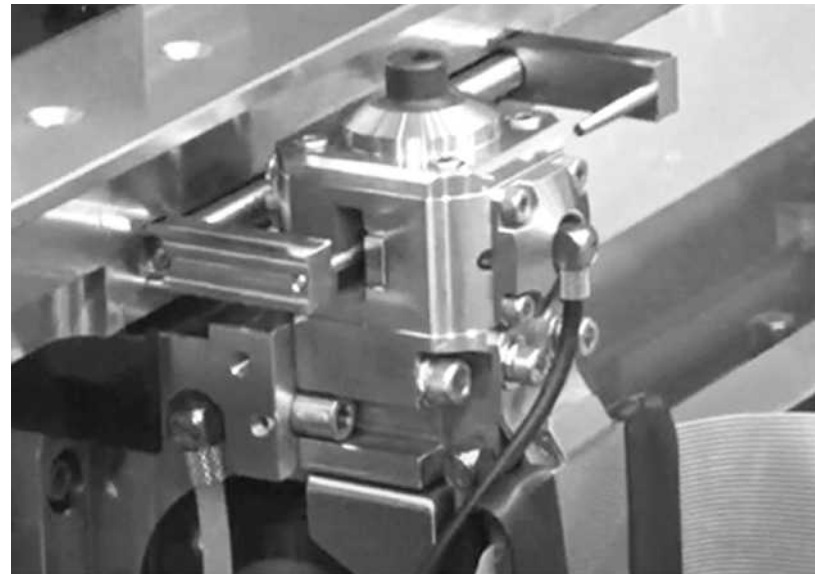
ソディックの通電コマ自動送り機能「ACPS」はワイヤ放電加工機の長時間にわたる連続稼働を実現する（ソディック提供）
