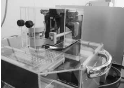
開発した質量分析装置に搭載可能なキャピラリー電気泳動システム
