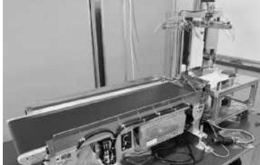
金属部品を自動で袋詰めする専用機を開発した
