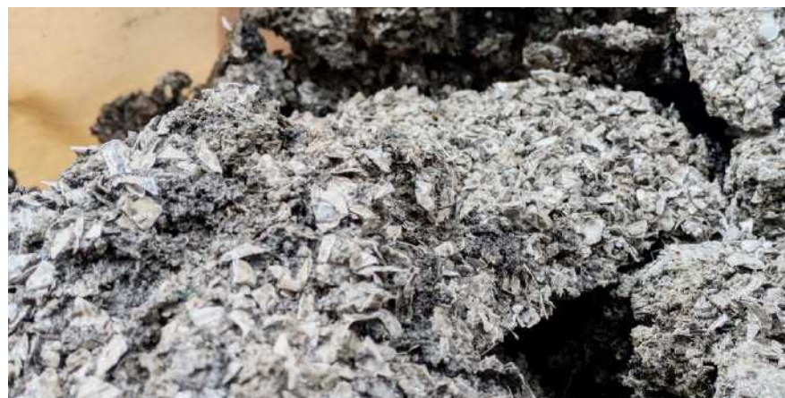
解重合工程ではPETフレークをエチレングリコールで溶かし、BHET分子に分解する。写真は解重合後に取り除かれたアルミや土砂、ラベルなどの不純物
