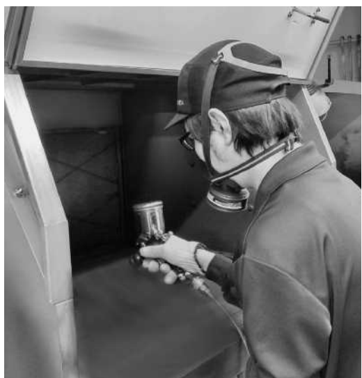
熊防メタルは黒クロムめっき上にコーティングする「KBM処理」に強み
