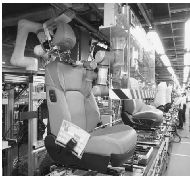
トヨタ紡織はシート組み立て工程の自動化に取り組み
