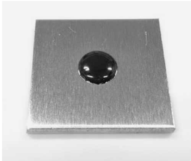
ノリタケが開発した、アルミニウムと低温で接合できるガラス材
