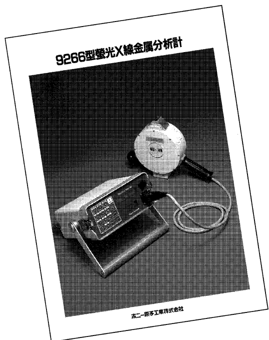
1984年ごろのカタログ。米国TEXAS NUCLEAR社製(現場用携帯形)9266型蛍光X線分析計。現在スクラップ業界などで多く使用されているハンドヘルド型蛍光X線分析計のはり的装置だった。
