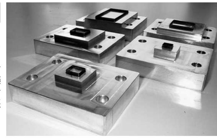
UNA-1200でコーティングした打ち抜き刃。シール・ラベルなどを打ち抜く金型で離型性を確保している
