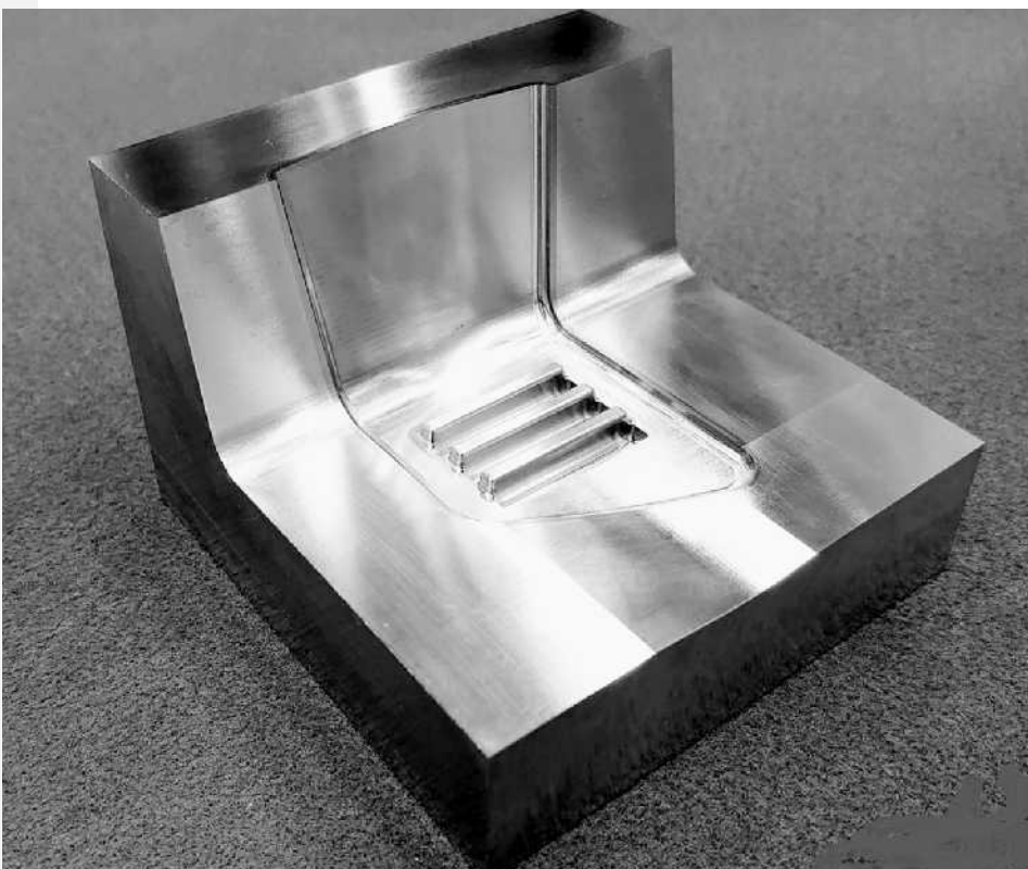
オークマは日本ガイシグループとともにベリリウム銅製金型への工具鋼の金属積層造形を実現した
