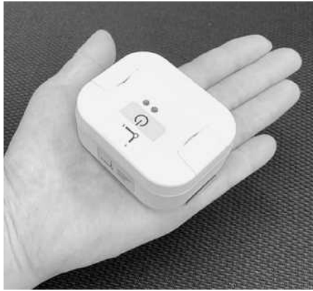
▲安価で小型のWi-Fi振動センサー「コナエアー」(中山水熱工業)
