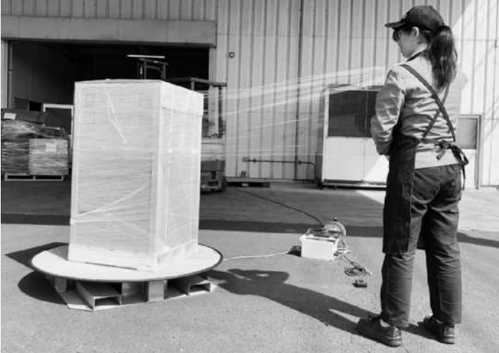
作業がしやすいシグママー技研のストレッチフィルム包装機
