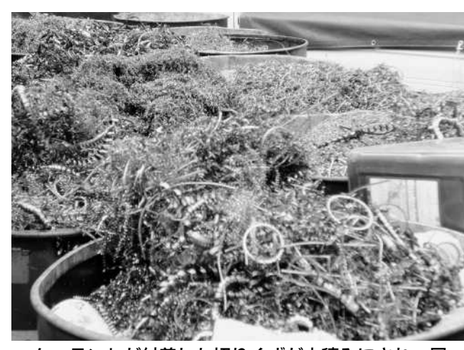
クーラントが付着した切りくずが山積みになり、屋外に置かれている例は少なくない
