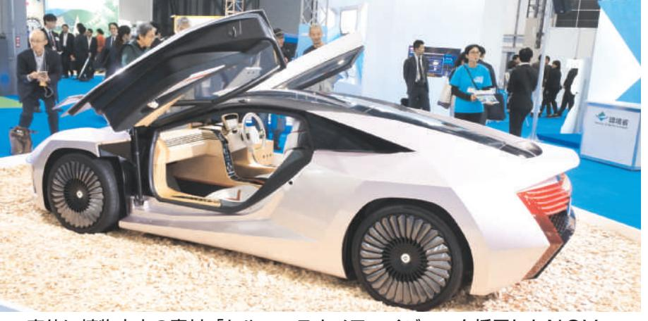
車体に植物由来の素材「セルロースナノファイバー」を採用したNCV(ナノ・セルロース・ピークル)。5面に記事)
