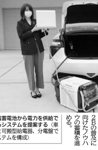
車載蓄電池から電力を供給できるシステムを提案する(車両と可搬型給電器、分電盤でシステムを構成)
