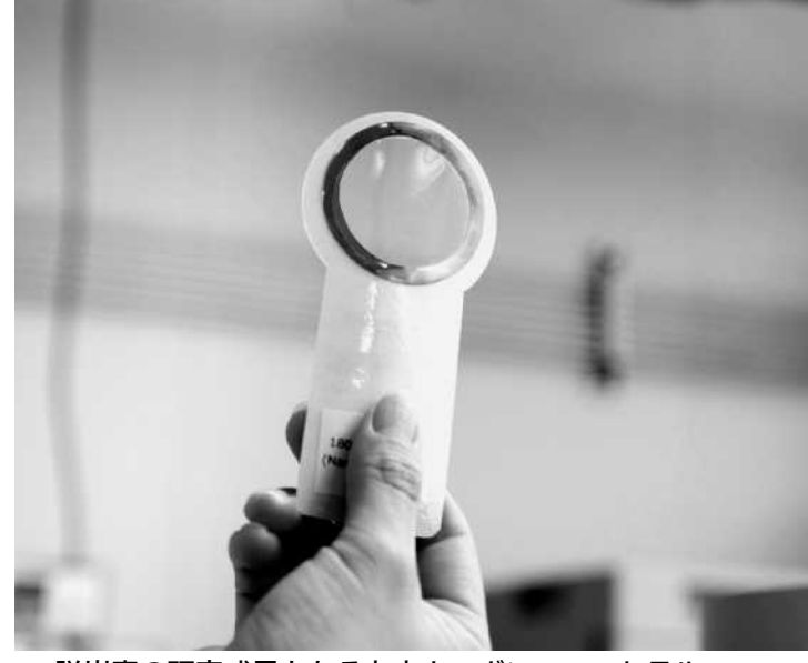
脱炭素の研究成果となる九大カーボンニュートラル・エネルギー国際研究所が開発した、大気中の二酸化炭素を回収するための世界最高クラスの性能を持つ分離膜
