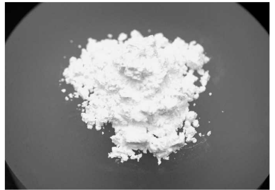
住田光学ガラス 住田光学ガラス(さいたま市浦和区)が開発したリチウムイオン伝導性酸化物結晶材料「セラパス」。リチウムイオン二次電池の固体電解質で、全固体電池への利用も視野に入れる。
