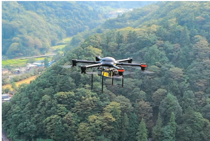
プログラミングに沿った自動操縦で高度約300mまで飛行できる
