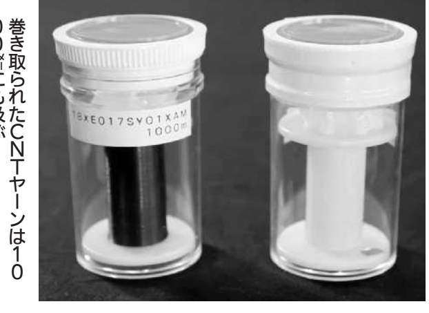
巻き取られたCNTヤーンは1000μmにも及ぶ
