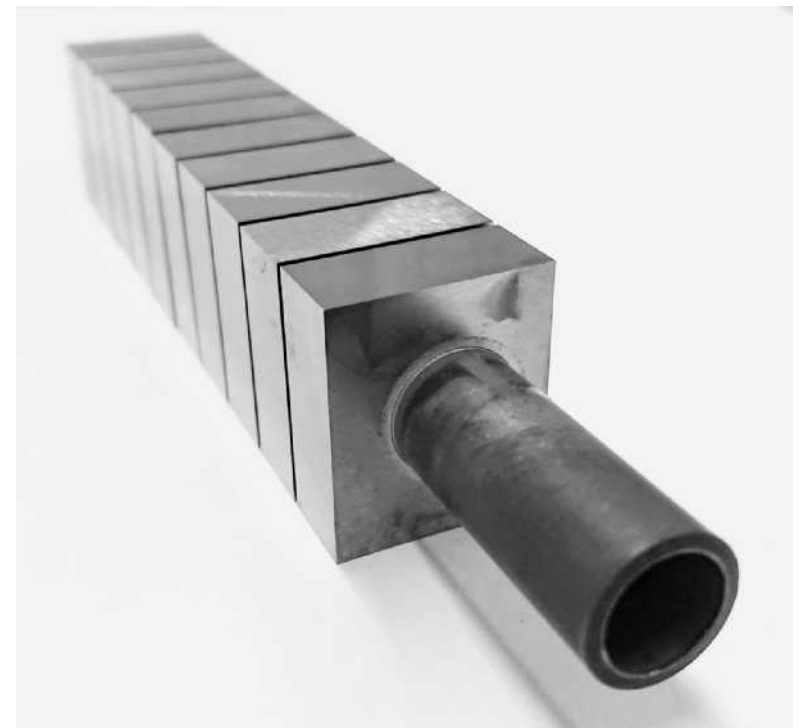
三芳合金工業 国際核融合実験炉(ITER)の冷却用部材として特殊銅合金を供給する三芳合金工業(三芳町)のサンプル材。
