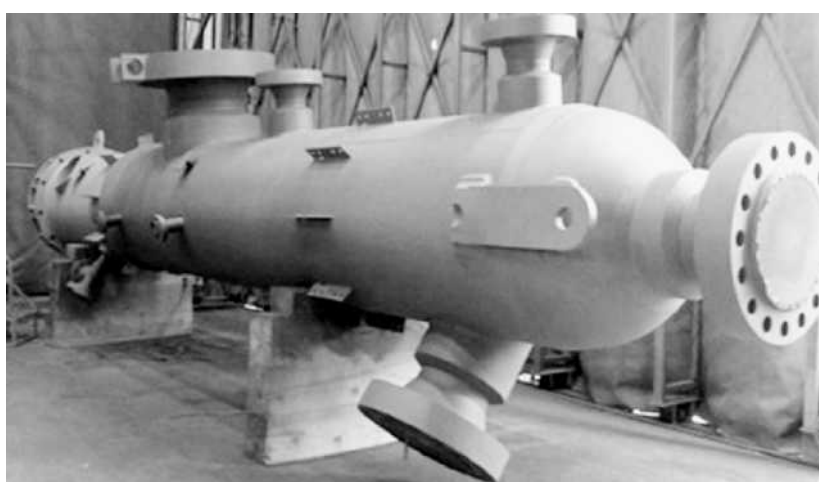
フィルターを搭載したガスセパレーターと内部フィルター(富士フィルター工業提供)
