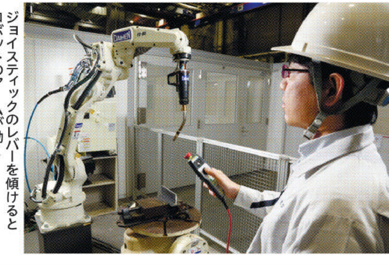
ジョイスティックのレバーを傾けるとロボットのアームが動く
