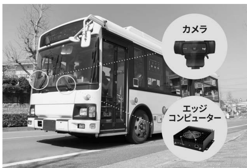
カメラを路線バスに搭載してパトロール業務を効率化
