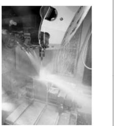
外部ノズルから同時に高圧でクリーン液を吐出させることで、深穴や複雑形状での切粉除去ができます。
