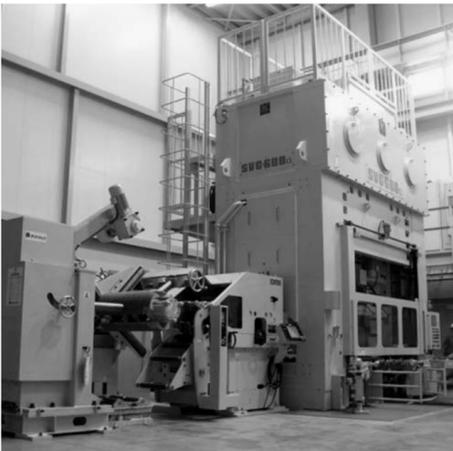
図5 オーダーメイドの高剛性・高精度3ポイントサーボプレス(サイバックコーポレーション)
