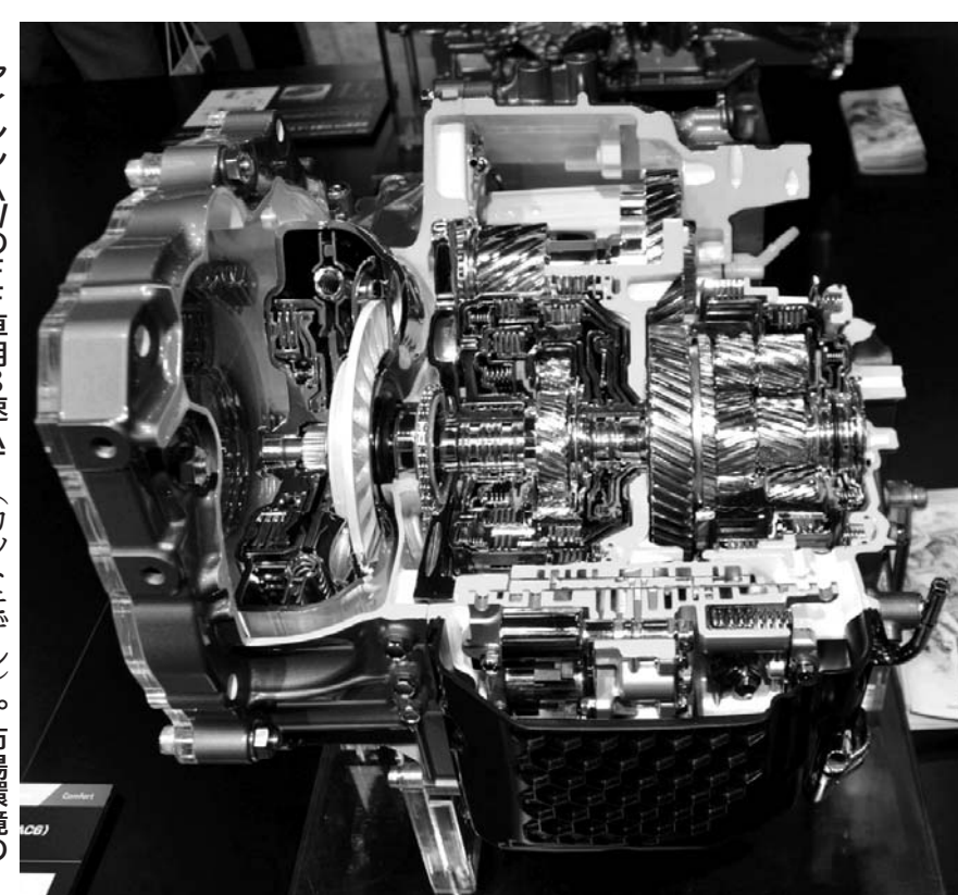
アイシンAWのFF車用8速AT(カットモデル)。市場環境の変化に対応すべく、変速機事業を再構築する。
