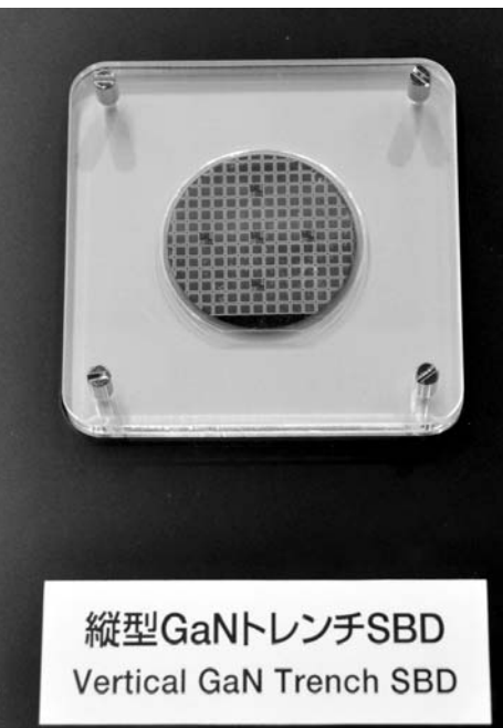
縦型GaNトレンチSBD Vertical GaN Trench SBD
