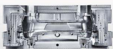
ワーク: パンバ用金型インサート 2,500 × 1,000 × 1,400 [mm]
