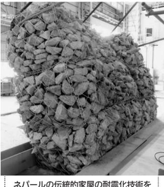
ネパールの伝統的耐震化技術を共同開発する ■地震で崩壊した石積み住宅(毛利建築設計事務所提供) ■蛇籠は揺れに対して変形したり傾いたりするが、倒壊しにくい(防災科研提供) =31日付
