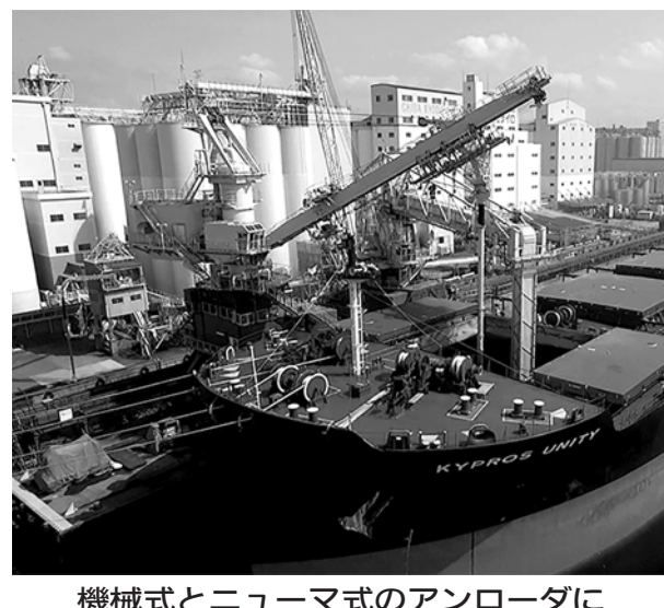
機械式とニューマ式のアンローダによる大型船からの効率的な荷役
