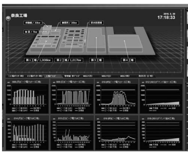
各種データを映し出す「D's FEMS」用大型タッチパネルモニター
