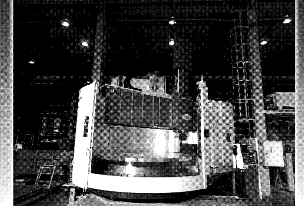
大型NC旋盤 東芝機械 TUE-200S φ2400
