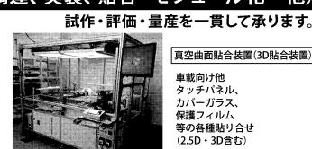
車載向け他 タッチパネル、 カバーガラス、 保護フィルム 等の各種貼り合せ (2.5D・3D含む)
