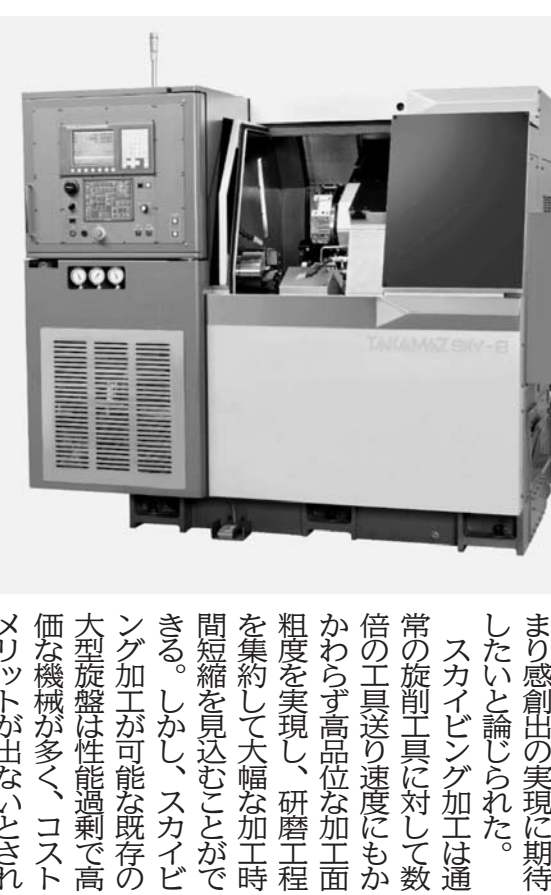
中格納部の造形処理は落差が大きく、今後、左右のバランスが取れたとまり感創出の実現に期待したいと論じられた。スカイピング加工は通常の旋削加工に対して数倍の工具送り速度にもかわらず高品位加工精度を実現し、研磨工程を省くことで大幅な加工時間短縮を見込めること。しかし、スカイピング加工が可能な既存の大型旋盤は性能過剰で高価な機械が多く、コストメリットが出ないといわれてきた。この製品は幅2700mm、奥行き1690mm、高さ1800mm、設置面積は約38平方メートルの従来機に比べて、優れたコストパフォーマンスを実現している。工程集約と研磨レス化といった観点から、さらなるコスト削減に寄与できるスカイピング加工の普及に期待が寄せられた。
