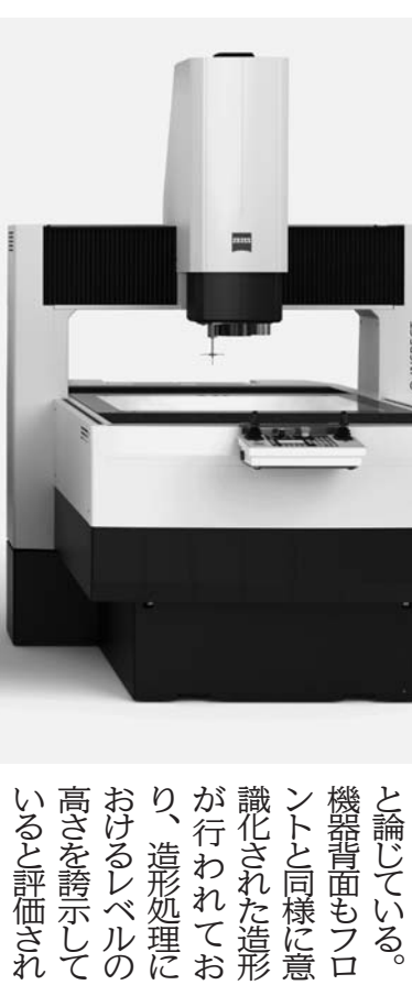
3種類のセンサーの得意な測定を組み合わせて、結果を融合し、測定可能な範囲の拡大と測定時の大幅短縮を実現している。温度環境については18～30度Cの温度範囲の中、ISO規格に準拠した精度保証が行える。光学式と接触式センサーの性能を最大限に引き出すのが、標準幾何要素配置されたブリッジを「フォーカスした汎用測定ソフトウェア」で搭載した「Z EISS CALYPS」を基本としている。審査ではこの製品の魅力を引き出すために、細かな表面形状を非接触で測定できる「ホワイトライトセンサ」の標準装備が期待が寄せられた。
