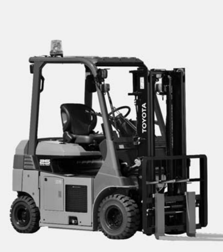
FCフォークリフトの普及拡大を図るにはFCセルの電位変動抑制、水点における始動、生成水の処理方式などの技術的課題や、導入コスト低減、水素ディスプレイの屋内設置など水素関連イムを大幅に低減し、作業効率の大幅な改善も実現している。
