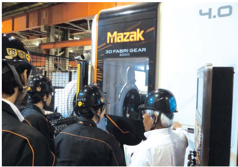
ヤマザキマザック 長尺パイプ・形鋼専用3次元 レーザ加工機 3D FABRI R I G E A R 4 0 0 I I I
