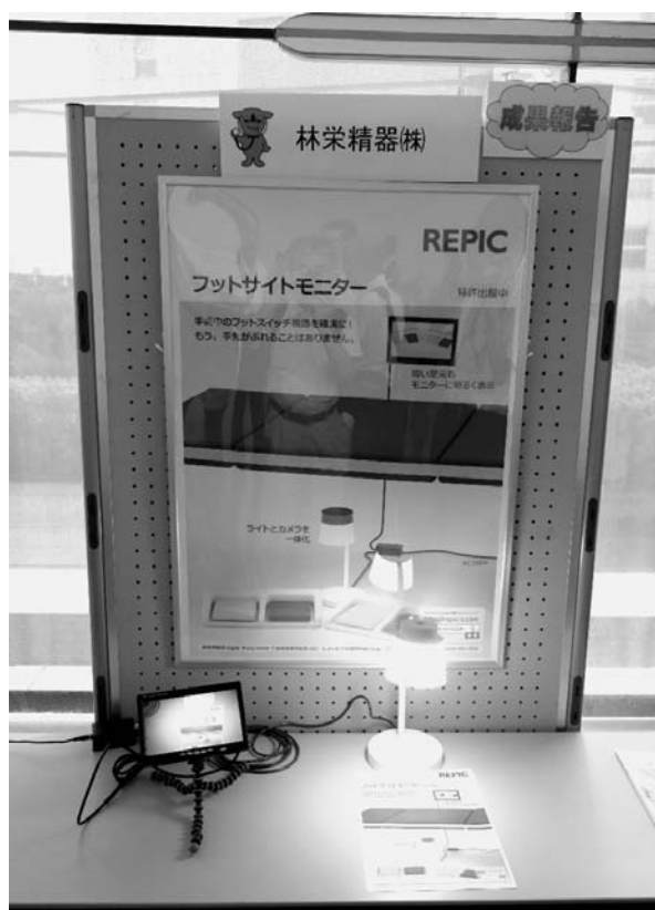
手術中のフットスイッチを確実に視認できるフットサイトモニター
