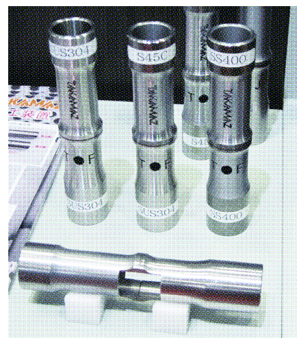
図3 切断・溶接などのレーザー複合機による例
