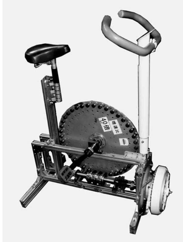
スクリーン増速機を搭載した人力発電装置
