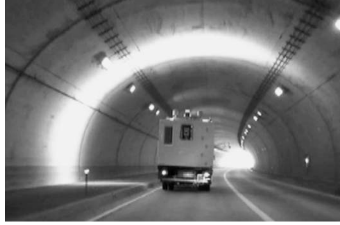
走行型計測車両 (MIMM) からトンネルの写真撮影とレーザー計測
