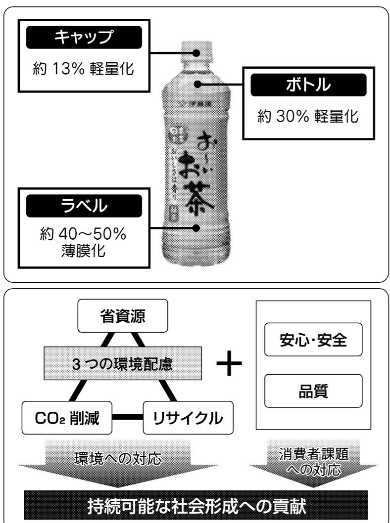
伊藤園は東洋製罐と共同で、容器の軽量化による環境負荷低減、香り保持・品質向上を目的に、緑茶飲料に最適な充填システム「新・飲料充填方式（N.S.システム）」を開発した。緑茶飲料には、自然、健康、安全はもとより、風味の纖細さなどにも高い水準が要求される。N.S.システムは持続可能な生産・消費という社会課題の解決に貢献する革新的な技術で、品質向上を図りつつ、省資源、二酸化炭素（CO<sub>2</sub>）削減、水資源リサイクルの「一石四鳥」を実現したのが特徴である。
