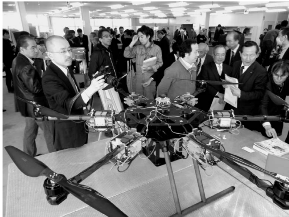
完全自律有線給電型重量級ヘリコプターはカメラを搭載し放射線計測などに使われる
