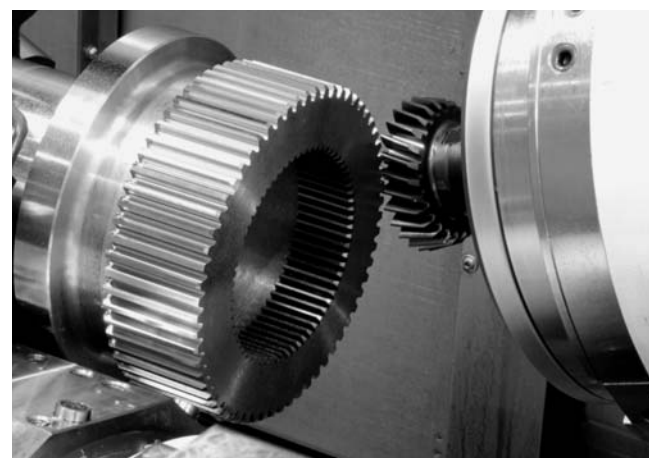
図3 スカイピング加工の例 (オークマ提供)
