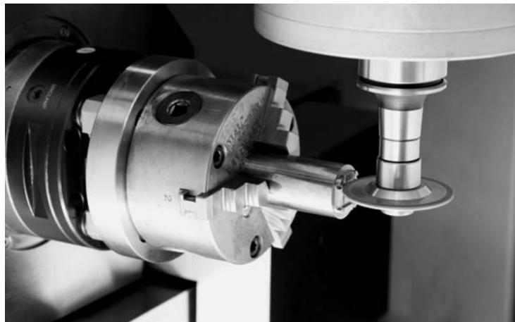
図5 ミーリングと研削の複合化の例 (アマダマシンツール提供)
