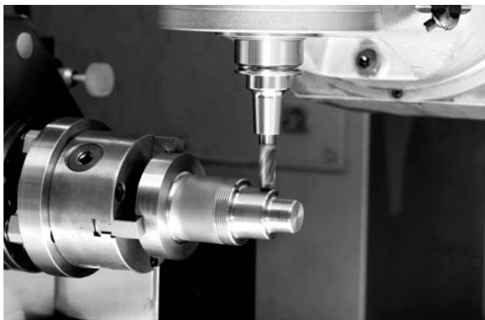
図4 ターンミリング加工の例 (アマダマシンツール提供)
