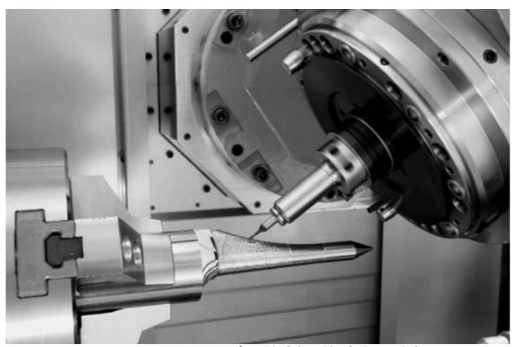
図2 ミーリングと旋削の複合化の例 (DMG森精機提供)
