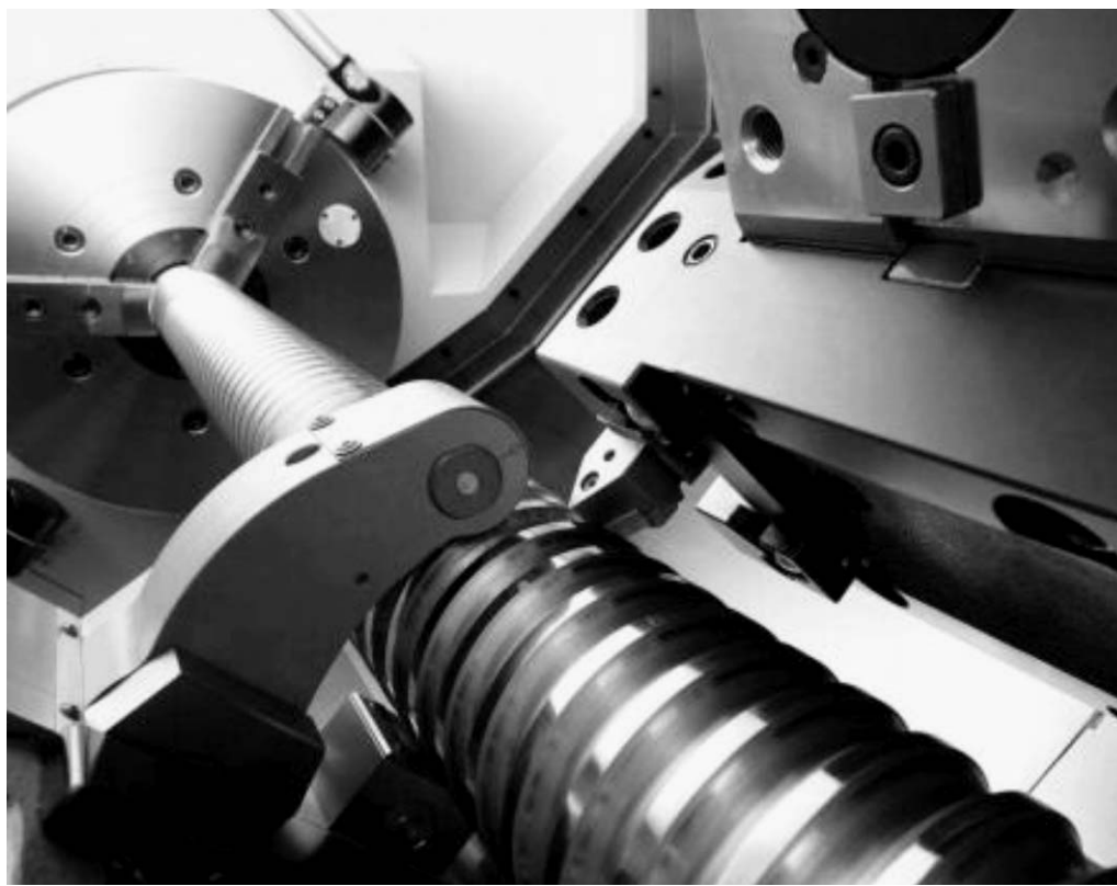
DMG森精機の大型4軸複合加工機「NX4000」での加工の様子
