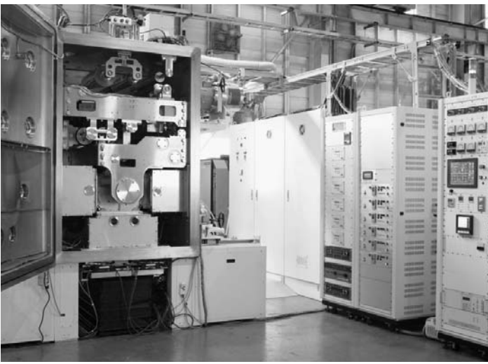
ロック技研工業の低抵抗成膜技術を用いた巻取り式真空成膜装置
