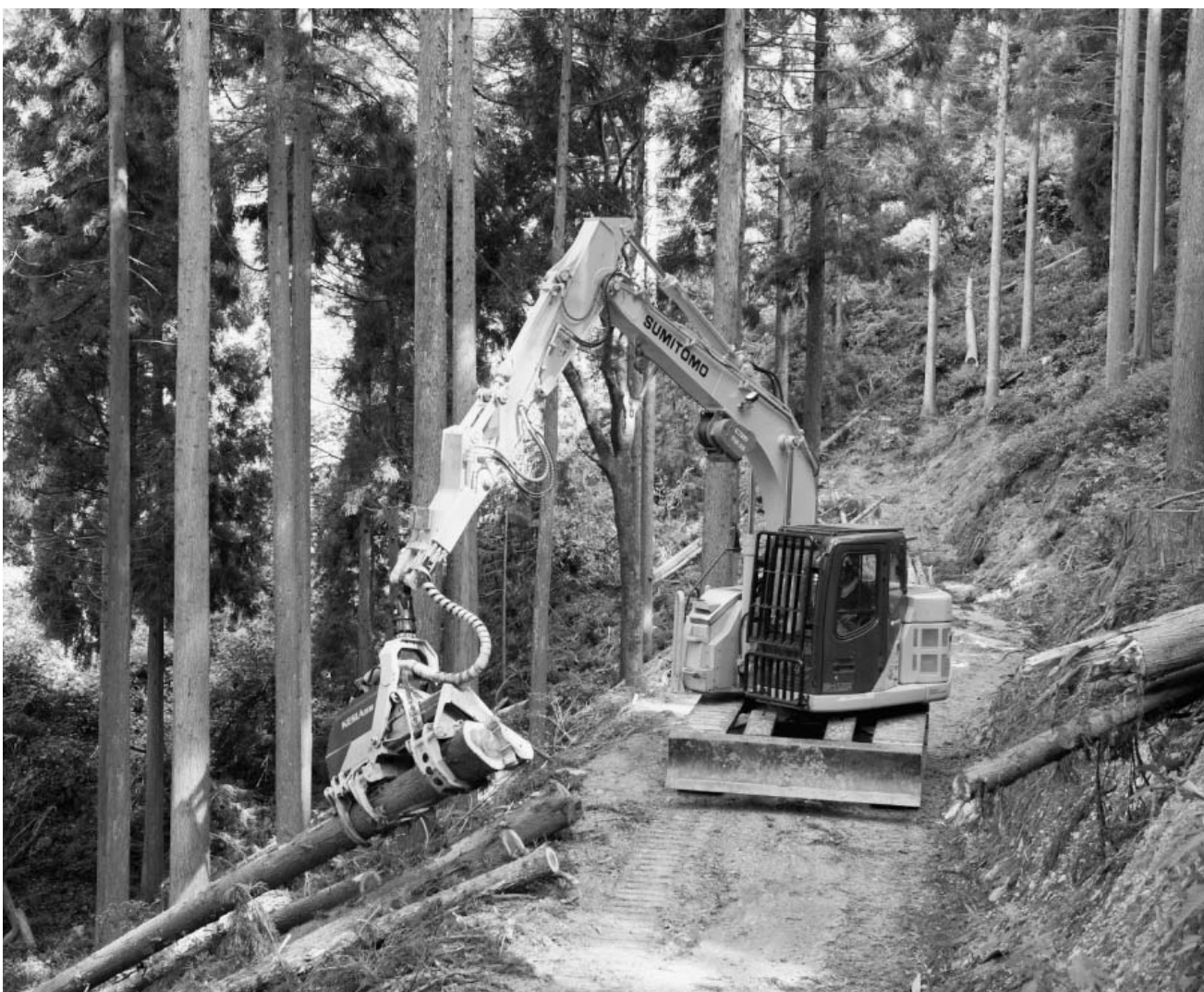
住友建機のクボタ製ハーベスタを装着した林業機械
