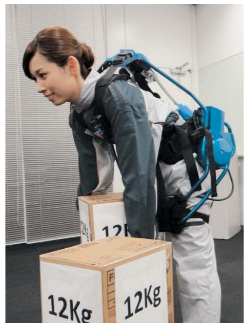
活躍の場を広げるロボットテクノロジー（パナソニック発のVBアクティプリンクが開発した装着型ロボット）
