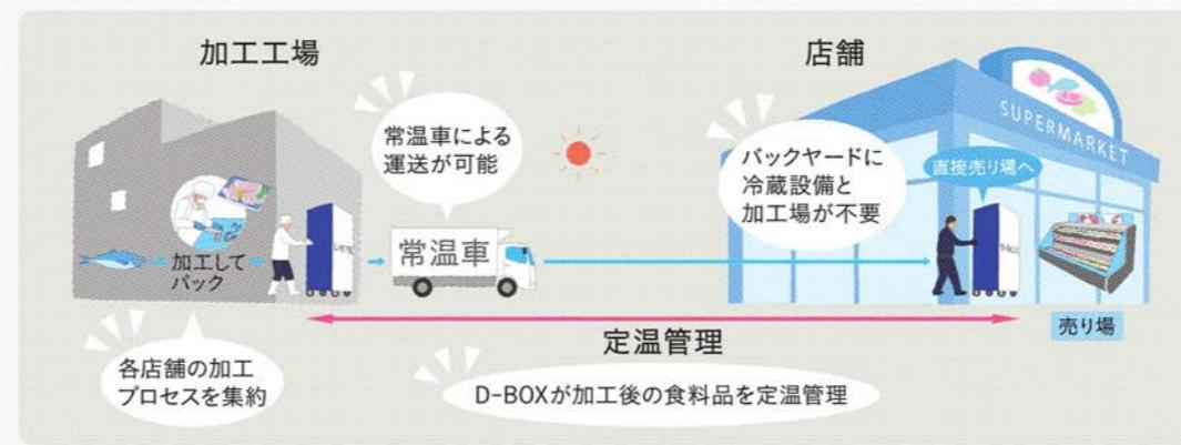
D-BOXに「トレーサビリティステーション\*」を接続することで、加工場から店舗・売り場までの庫内温度経過と扉開閉履歴が記録できます。さらに、クラウド環境を利用した「HQCCS(ハイクオリティコールドチェーンシステム)\*」で、トレーサビリティ情報とPOS集計情報とを連携。食の安全・安心の信頼性を高めると共に、戦略的なマーチャンダイジングをサポートします。
