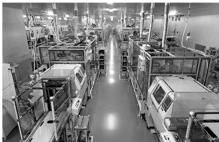
太平洋工業のTPMS送信機の自動生産ライン
